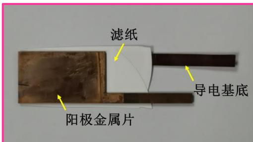
4. 将导电基底/AAO 模板/滤纸/阳极金属片防止在支架的下玻璃压板表面，AAO 的位置与压紧螺丝对齐，小心盖上上玻璃压板，此时如果发现位置有所偏离，可以适当调节相对位置。
