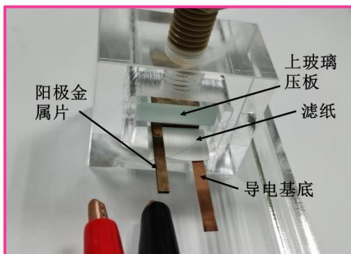
5. 用手拧动 PEEK 螺丝，让它顶在上玻璃压板表面，然后用扳手再用力拧紧。用扳手拧的时候用力也不要太大，防止把支架顶裂。红色和黑色鳄鱼夹分别连接阳极金属片和导电基底。连接完成之后，将支架竖直放入空的用来盛放电沉积溶液的容器中（比如烧杯）。然后缓慢添加电沉积溶液，让溶液略微淹没上压玻璃压板即可，注意电沉积溶液不可接触鳄鱼夹。此处为了方便演示，并没有往烧杯里添加电沉积溶液。最后红色和黑色导线分别连接外电路直流电源的正极和负极。加上电压，监控电流即可进行电沉积了。由于电流一般较小，建议使用精度达到 0.1mA 的五位电流表。电沉积铜和镍时使用的金属阳极片分别为磷铜片阳极和高纯镍片阳极，属于耗材，后续使用以及其它规格使用都需要客户自己购买和加工。
