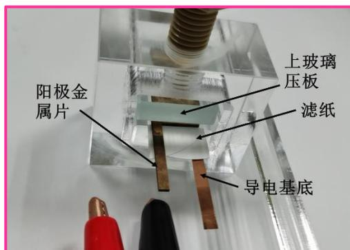
5. 用手拧动 PEEK 螺丝，让它顶在上玻璃压板表面，然后用扳手再用力拧紧。用扳手拧的时候用力也不要太大，防止把支架顶裂。红色和黑色鳄鱼夹分别连接阳极金属片和导电基底。连接完成之后，将支架竖直放入空的用来盛放电沉积溶液的容器中（比如烧杯）。然后缓慢添加电沉积溶液，让溶液略微淹没上压玻璃压板即可，注意电沉积溶液不可接触鳄鱼夹。此处为了方便演示，并没有往烧杯里添加电沉积溶液。最后红色和黑色导线分别连接外电路直流电源的正极和负极。加上电压，监控电流即可进行电沉积了。由于电流一般较小，建议使用精度达到 0.1mA 的五位电流表。电沉积铜和镍时使用的金属阳极片分别为磷铜片阳极和高纯镍片阳极，属于耗材，后续使用以及其它规格使用都需要客户自己购买和加工。
